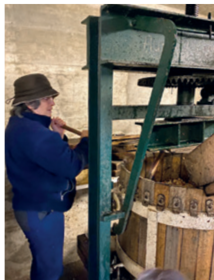
Elisabeth Wyss verteilt die zerkleinerten Apfelstücke vor dem Pressen in der Räder-Joch-Presse der Marke Bucher-Guyer von 1931
